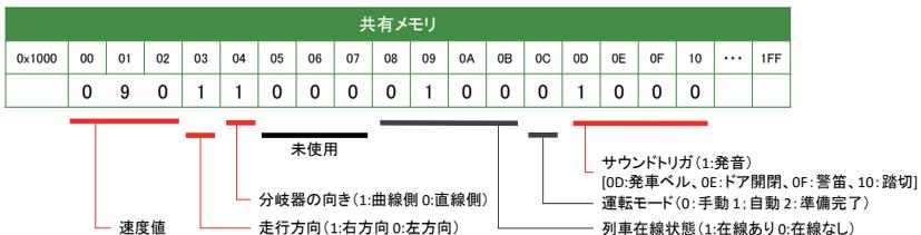
図 3: 鉄道模型ミニレイアウトの共有メモリのコマンドアサイン
