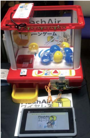
図 3-9: ワイヤレスクレーンゲーム
