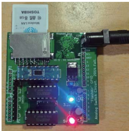
図 3-10: GPIO のための インターフェイス基板製作例
