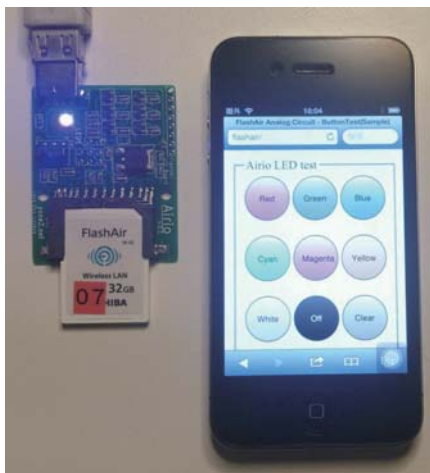
図 4-6: GPIO 機能の動作確認
