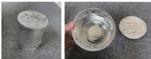
図 2: アルミホイルと缶で自作したシールドボックス
