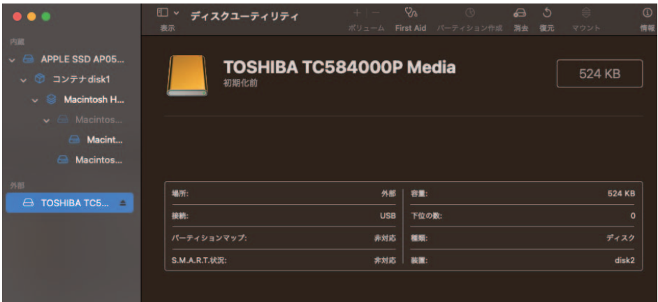
図 6: Arduino Mega を Mass Storage として認識させた様子
